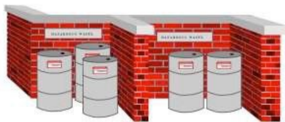
Slika 6.7.5. Način odvajanja nekompatibilnog otpada/materijala
