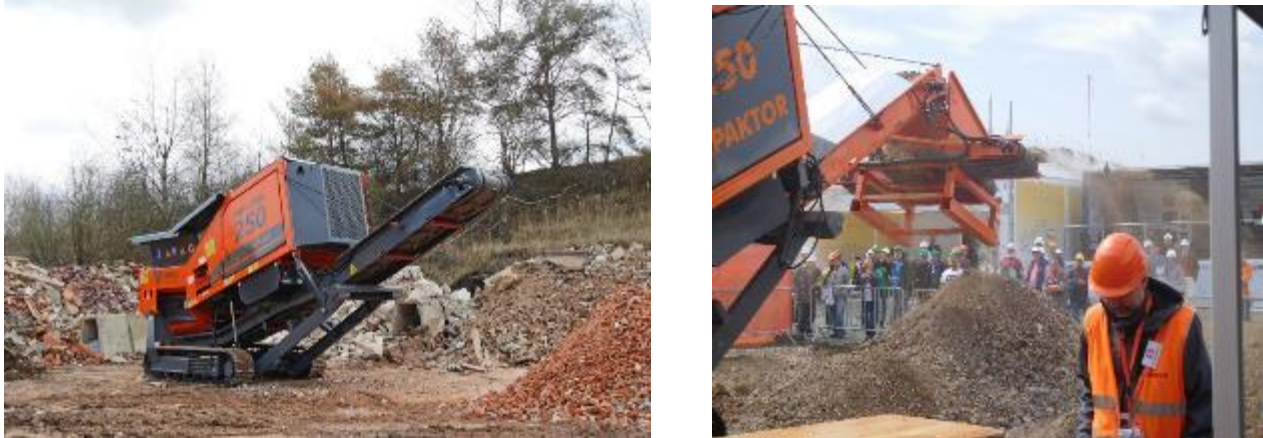
Slika 14.3-2. Mašina/postrojenje za tretman otpada od građenja i rušenja, (drobilitica, magnetni separator - slika levo i sito na kraju konvejerera (slika desno)
