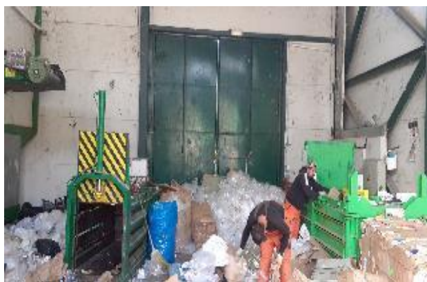
Slika 6.1-5. Horizontalne poluautomatske prese (levo) i automatska presa za baliranje otpada (desno)
